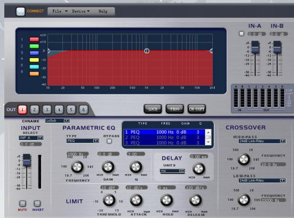
通过USB和RS485接口可连接电脑，通过RS485接口可最多连接250台机器和超过1500米的距离外用电脑来控制
