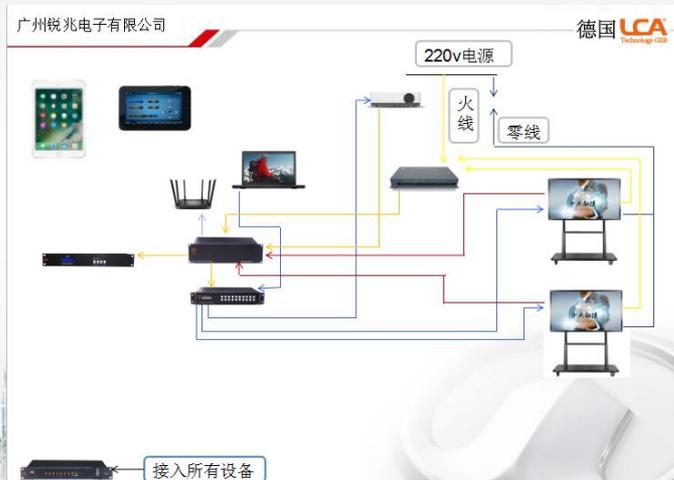
中央控制系统是指对声、光、电等各种设备进行集中控制的设备。它应用于多媒体教室、多功能会议厅、指挥控制中心、智能化家庭等，用户可用按钮式控制面板、计算机显示器、触摸屏和无线遥控等设备，通过计算机和中央控制系统软件控制投影机、展示台、影碟机、录像机等设备。它可实现资源共享、影音互传和相互监控。协同控制计算机、影碟机、录像机、视频展台等现代视听设备，并集中控制电动窗帘、灯光、幕布等设备，通过大屏幕投影，营造出一个高清晰、高保真、受控声光背景的现代化多媒体视听教学环境。
